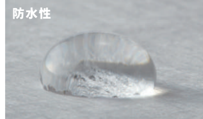
湿気は通しても、外部からの雨水の浸入を防ぐ
