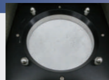
防水性試験の様子
