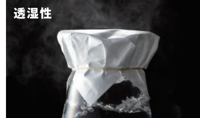
優れた透湿性で構造材の乾燥状態をキープ
